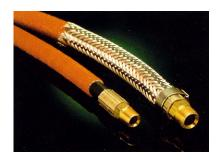
Le Manchon de fibre de verre enduit de Silicone est fabriqué de fils de fibre de verre tressés ensemble pour former un manchon, qui est ensuite recouvert avec une couche épaisse de silicone haute température. Ce produit ne contient aucun amiante. Disponible dans les dimensions de ¼ po à 3 po D.I.
