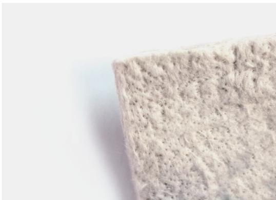
La natte 1200 est une couverture d'isolation faite de fibres liées croisées mécaniquement de densité uniforme, offerte en différentes épaisseurs et offre une performance fiable et supérieure jusqu'à 649°C (1200°F). La natte 1200 est fabriquée à partir de longues fibres de textile bien contrôlées pour assurer une liaison mécanique uniforme.
