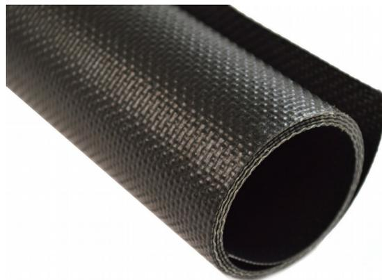
Trois couches à haute résistance de film de PTFE ont été stratifiées pour produire la barrière. La barrière de PTFE résultante de 0,009 po. (0,23 mm) d'épaisseur est durable, flexible, et résistante aux fissures dues au stress.
